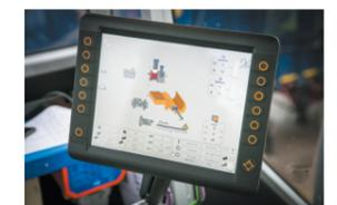
Les **KOLOSS** sont équipées en standard du nouveau **système de télémaintenance Webvisu** mis au point par LEFORT®. Ce dispositif permet à partir de **n'importe quel support numérique** - PC, tablette, téléphone portable - de collecter des données précises de production, **de surveiller et d'intervenir sur la machine en temps réel**, et ainsi d'optimiser l'exploitation et la maintenance.
