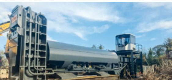
KOLOSS 1000, caisse de 8 m, force de chaque volet de compression : 400 t, moteur diesel de 600 HP (version électrique possible)
